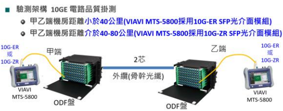
圖 3-6 骨幹光纖每一區段線路品質驗測架構
